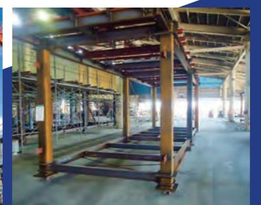
SSUT(サット)工法(※)は、低予算や短工期など、現在の建設業が抱える課題に応える工法の一つです。建物を基準となるパースに細分化し、それらを1つのユニットとして工場製作。現場では積み木を積むようにそのユニットを組み立てるだけで建物が完成するので、圧倒的な工期短縮や、人手不足、低資源化などの課題改善が図れます。
